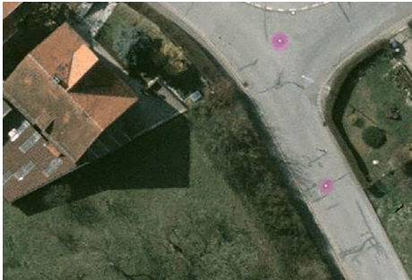
Ahorn bei Coburg, Katasterbefliegung 1994, Signalisierte Punkte (siehe pink farbige Markierung) © BVV
